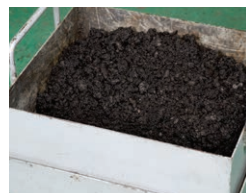
材質:SK 加工機:平面研削盤
