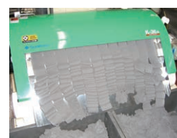
スラッジ材質：鉄 加工機：歯車研削盤
