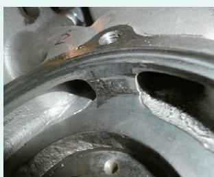
ケーシング内部（仕切部） 配管荷重による接触跡
