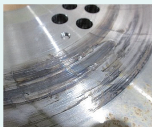
制御板(裏面) インペラー接触傷、変色
