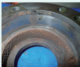
ベアリングケース クリープ摩耗跡
