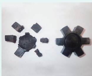
カップリングゴム 経年劣化による破断 左：旧品 右：新品
