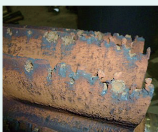
インペラー キャビテーションによる損傷
