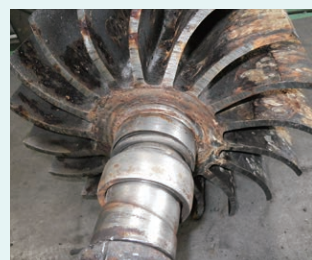
インペラーシャフト 接触による損傷
