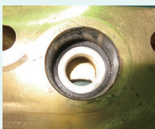
セラミックバルブ割損
