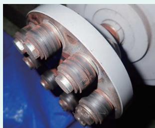
カップリングゴム 芯出し不良による早期摩耗
