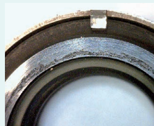
メカニカルシール ドライ摩耗跡 (拡大)
