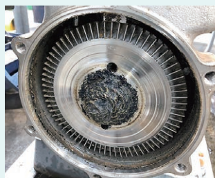
インペラー 汚泥混入による摩耗
