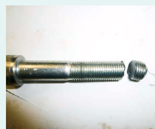
締切運動によるセンターボルト折損
