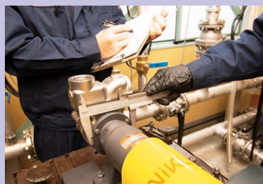
精度検査 最終品質検査で は、品質及び外 観を点検します。
