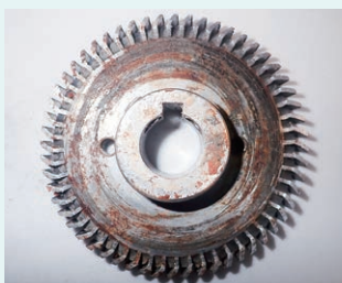
インペラー 接触による摩耗
