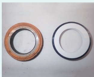
メカニカルシール 経年摩耗、変色 左：旧品 右：新品
