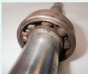
ベアリング 損傷状態
