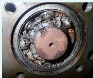
ベアリング 潤滑不良による破損
