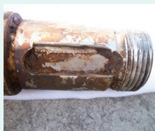
シャフト キー溝部破損
