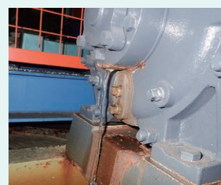
ベアリングケース下部 メカ漏れ（多量）
