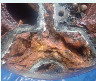
ポンプカバー内部 錆による水通路閉塞
