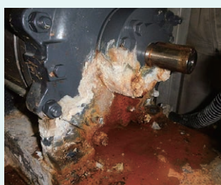
メカ漏れによる外部腐食
