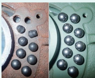
テフロンボール 経年摩耗、変形 左：旧品 右：新品
